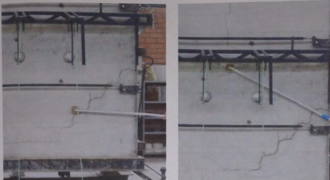
**Figura 7 – Teste do chumaço de algodão sobre uma fissura formada na parede.**
